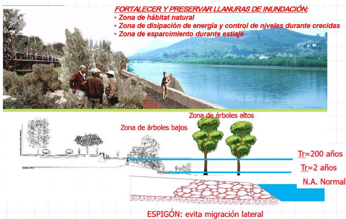
Figura III-9 Esquema y Corte de DDFF con objetivos ecológicos
